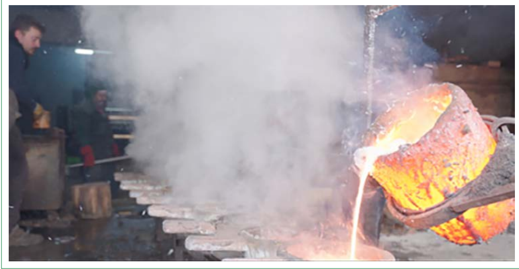
Şekil 8. Anatolian Cymbals atölyesinde geleneksel yöntemlerle yapılan zil dökümü.
